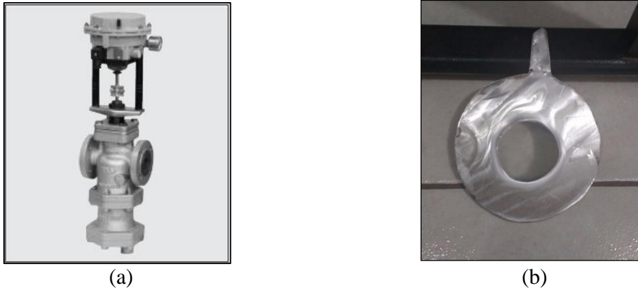
FIGURA 3 – Exemplo de válvula de controle automática e placa de orifício fabricada
